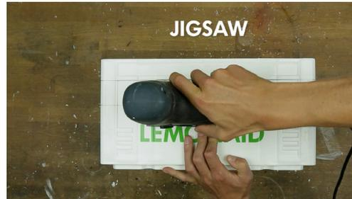
**10.** Säge entlang der so entstandenen durchgehenden Linien von einer Kistenseite zur anderen.
