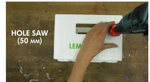
4. Bohre mit der Lochsäge je ein 50 mm breites Loch am Schnittpunkt der Markierungen der linken Seite...
